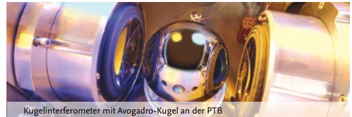
Kugelinterferometer mit Avogadro-Kugel an der PTB
